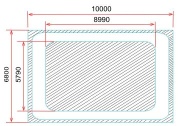
Die size: 10000μm x 6800μm Bond pad size: 8990μm x 5790μm
